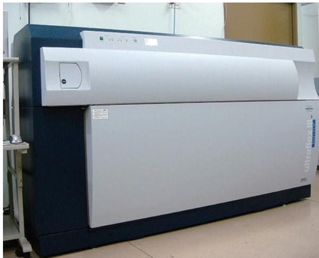
MALDI-TOF/TOF型質量分析装置 (ultraflex III)
